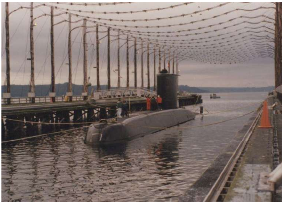
El SS. Simpson es sometido a Pruebas de Degaussing. (Fuente: Fotografía propiedad autor artículo).
