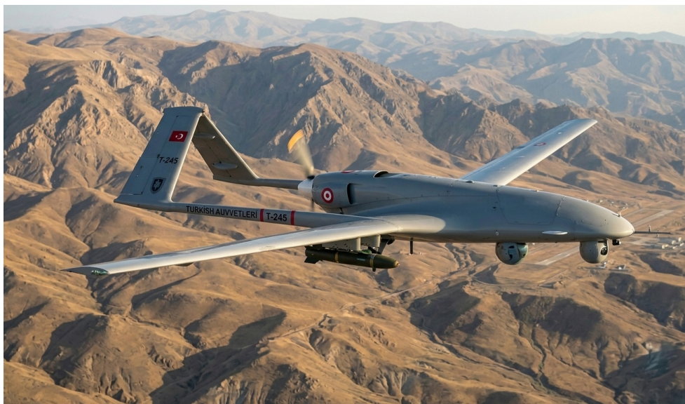
Bayraktar TB2 es un vehículo aéreo de combate no tripulado (UCAV) de altitud media y gran autonomía, fabricado por la empresa turca Baykar. (Fuente: Géminis IA)
