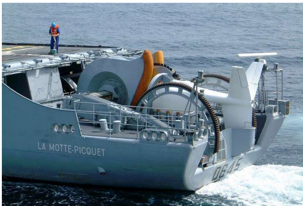
Las fragatas francesas de tipo F70, incorporan un sonar de profundidad variable (VDS) de tipo DUBV43 o DUBV43C. (Fuente: Wikimedia Commons)
