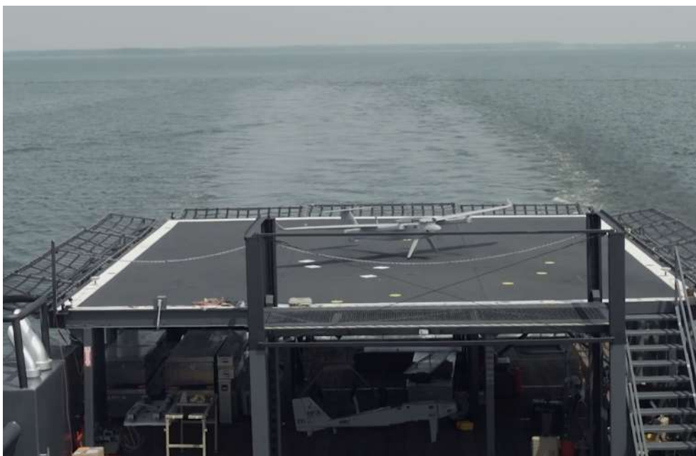
Figura N°2: UAV VTOL Jump-20 en plataforma de vuelo. (Fuente: AeroVironment).
